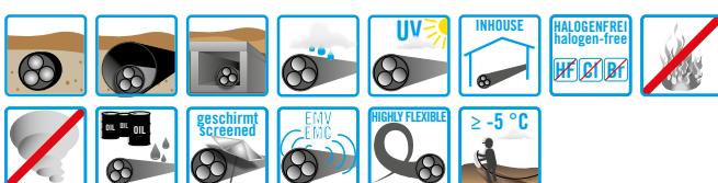
Halogenfreie und hochflammmwidrige Energie- und Steuerleitungen zum Anschluss und zur Verbindung von elektrischen Anlagen, speziell bei erhöhten Anforderungen an die elektromagnetische Verträglichkeit EMV (electromagnetic compatibility EMC)
