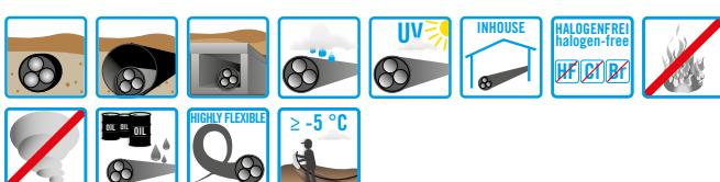
Hochflammmwidriges, flexibles Energie-, Anschluss- und Verbindungsleitungskabel für den Einsatz im Anlagen- und Maschinenbau für Bauwerke mit sehr hohem Sicherheitsbedarf, z. B. in Tunneln, unterirdischen Bahnhöfen, Krankenhäusern und in Rettungswegen
