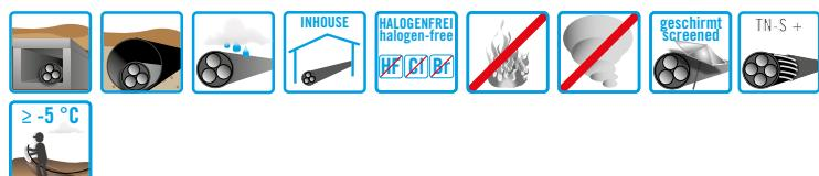
Starkstromkabel mit verbessertem Verhalten im Brandfall, halogenfrei, flammwidrig und raucharm z.B. für Kraftwerke, Industrie- und Schaltanlagen, sowie in Ortsnetzen, wenn ein Schutz gegen Berührungsspannung bei mechanischer Beschädigung erforderlich ist. (Siehe DIN VDE 0298-1)
