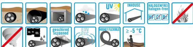
Hochflammwidrige, doppelt geschirmte halogenfreie, flexible, UV- und witterungsbeständige, erdverlegbare Gleichstrom Anschluss- und Verbindungsleitung mit einer sehr temperaturbeständigen Leiterisolierung für den DC-Einsatz im Anlagen- und Schaltschrankbau - speziell bei erhöhten Anforderungen an die elektromagnetische Verträglichkeit EMV (electromagnetic compatibility EMC)
