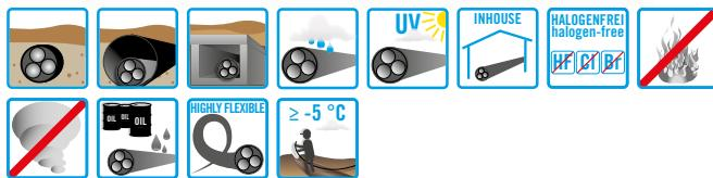
Hochflammwidriges, flexibles, symmetrisch angeordnetes Gleichstromkabel für hohe EMV Ansprüche in Bauwerken mit hohem Brandschutz und technischem Sicherheitsbedarf, z. B. in Rechenzentren, Krankenhäusern, Schulen, Büro, Gewerbe und Industrie, Forschung und Entwicklung
