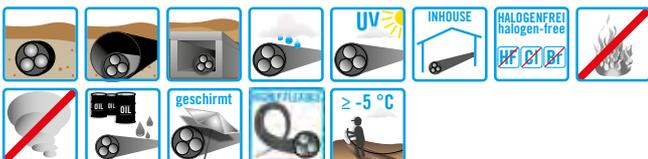
Hochflexible, halogenfreie, flammwidrige, UV- und witterungsbeständige, erdverlegbare Gleichstrom Anschluss- und Verbindungsleitung mit konzentrischem Leiter und einer sehr temperaturbeständigen Leiterisolierung für den DC-Einsatz im Anlagen- und Schaltschrankbau.
